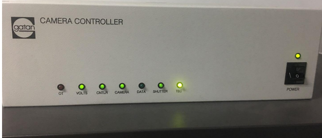
Gatan Ultrascan 1000XP CCD 相机控制器放置在镜筒左侧电子控制柜 1 上。
